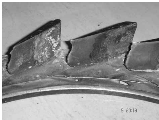
Рис. 1. Повреждение соплового аппарата ТНА типа NR
