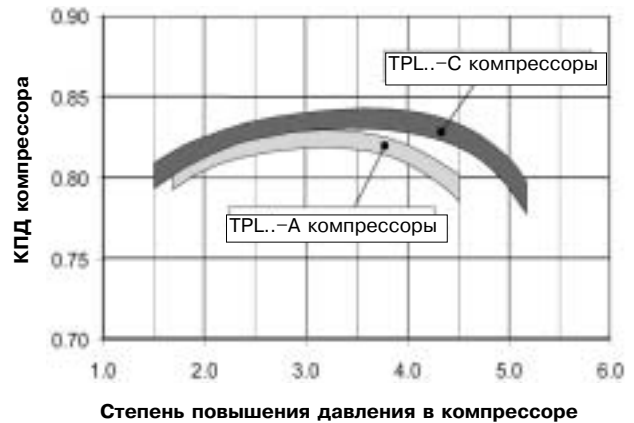
Рис. 2. Сопоставление КПД компрессоров турбокомпрессоров рядов TPL-A и TPL-C
