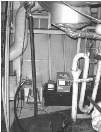
Рис. 3. Размещение газоаналитической аппаратуры в машинном отделении судна
