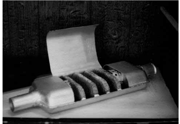
Рис. 1. Нейтрализатор на базе глушителя 60-1205015-А(ММЗ)
