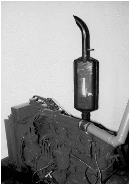
Рис. 2. Стендовые испытания нейтрализатора-глушителя в ОКБ «Минский тракторный завод»
