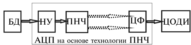
Рис. 1. Структурная схема измерительной системы на основе ПНЧ
