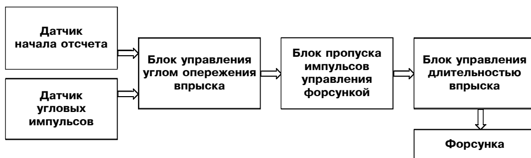
Рис. 1. Схема системы фазированного впрыскивания топлива с возможностью пропуска части циклов
