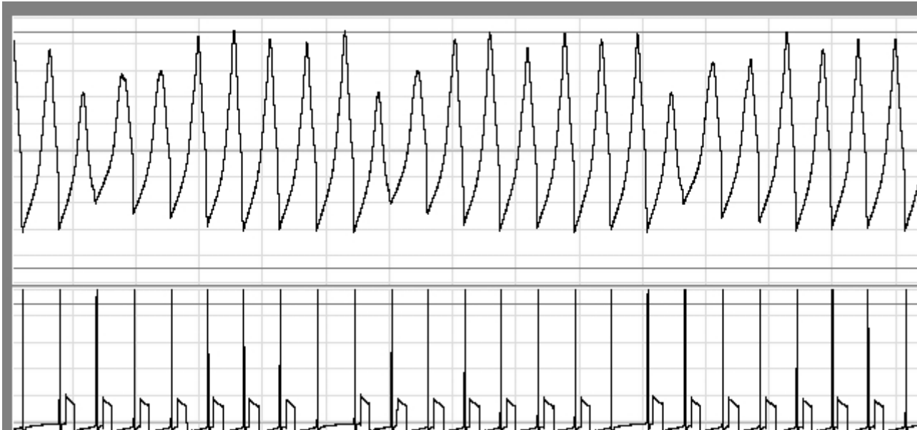
Рис. 3. Индикаторные диаграммы рабочего процесса РПД при пропуске 1-го цикла из 8-ми (отключено 12,5 % циклов)
