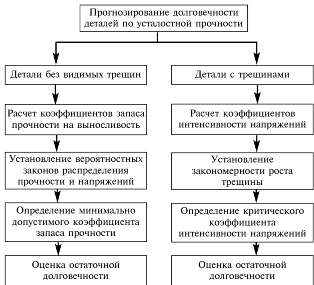
Рис. 1. Укрупненная блок-схема алгоритма оценки долговечности деталей судовых ДВС по усталостной прочности
