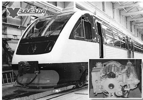
РА-2 дизель-поездов, состоящих из двух, трех, четырех вагонов с подвагонным размещением силовой установки на базе форсированного горизонтального дизеля М721-01.
