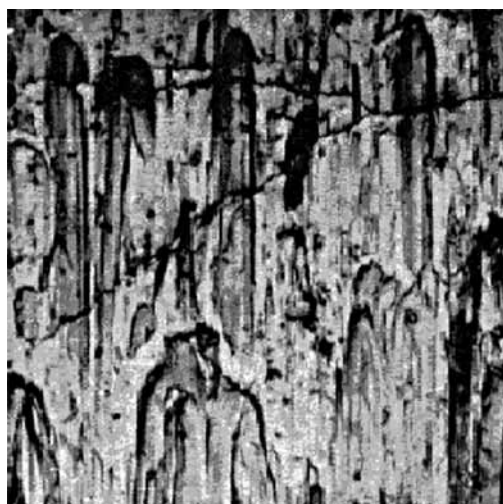
Рис. 2. Состояние рабочей поверхности гильзы на участке 1, соответствующем положению верхней кромки ВКК в ВМТ (ув. 400х)
