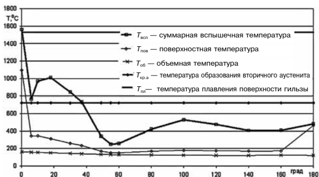
Рис. 7. Зависимость температуры в зоне контакта ВКК-гильза цилиндра дизеля 8ЧН13/14 от угла поворота коленчатого вала двигателя
