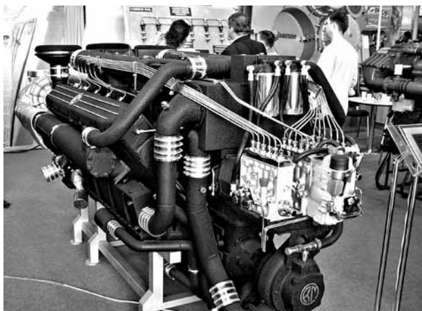
W-образный дизель D/SS-BR2 фирмы CRM
