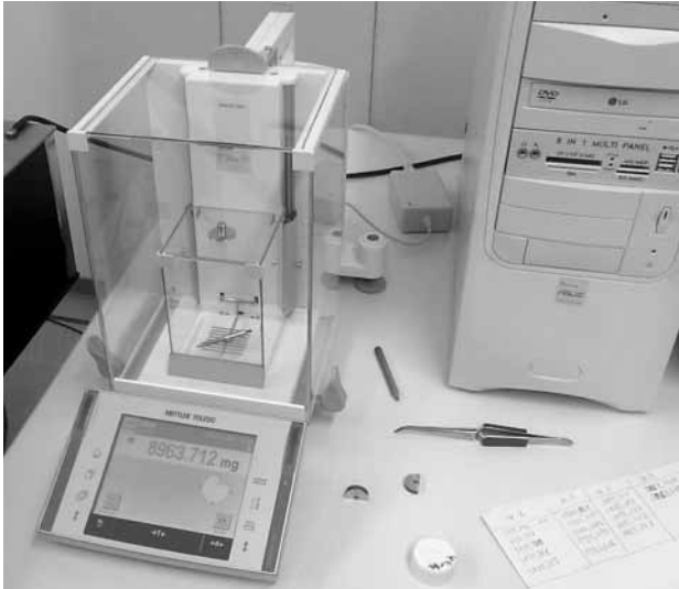
Рис. 2. Электронные весы для измерения объектов массой до 52 г с точностью 10^{-9} кг
