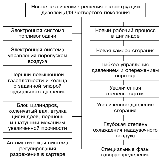
Рис. 5. Отличительные особенности двигателей Д49 четвертого поколения
