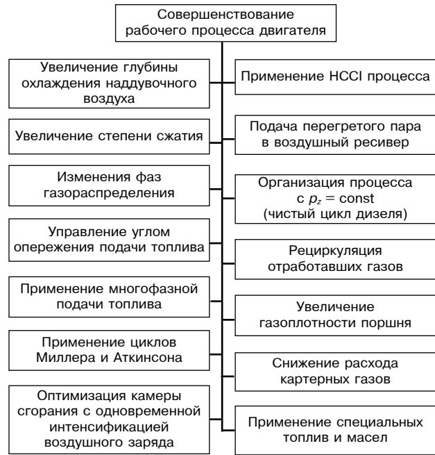
Рис. 1. Основные способы совершенствования рабочего процесса двигателя
