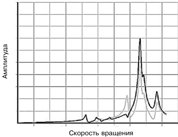
Рис. 20. Частотные функции отклика (перемещений) кончиков лопаток полной и укороченной. Большие перемещения — полная лопатка
