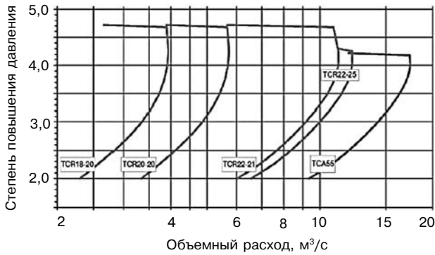
Рис. 31. Область стыковки турбокомпрессоров TCR/TCA для мощностей 2-х тактных дизелей
