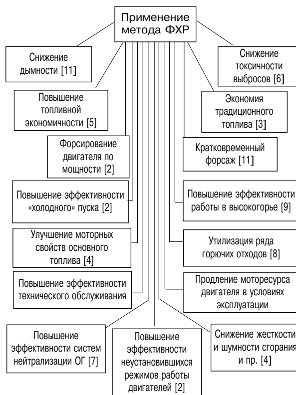
Рис. 6. Схематическое представление основных целей, достижение которых возможно методом ФХР на основе применения альтернативных топлив
