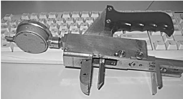
Рис. 2. Прибор для измерения удлинения и длины втулочно-роликовых цепей
