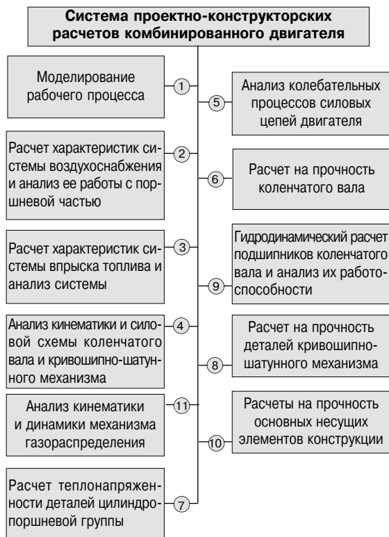
Рис. 2. Схема аналитических моделей, входящих в систему проектно-конструкторских расчетов двигателей
