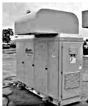
Рис. 1. Установка ТА-100 RCHP с микротурбиной
