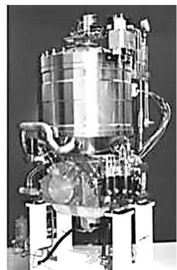
Рис. 3. Двигатель Стирлинга фирмы «Kockums» (Швеция) для подводных лодок
