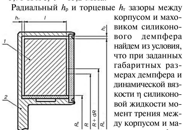
Рис. 5. Схема жидкостного демпфера: 1 — маховик; 2 — корпус
