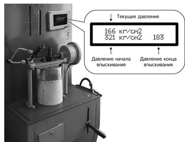
Рис. 3. Фотография модернизированного стенда А106.2 и схема вывода данных на ЖКИ
