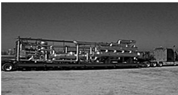
Рис. 4. Комплекс сжижения природного газа фирмы «Криопак»
