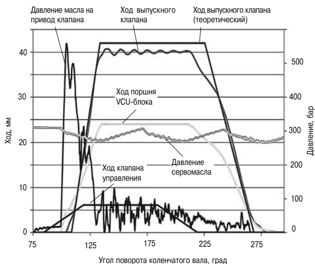
Рис. 7. Изменение основных параметров системы привода выпускного клапана дизеля типа RT-flex нового поколения в процессе хода клапана
