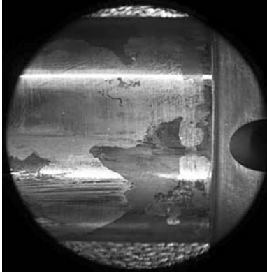
Рис. 2. Отложения на стенках втулки насоса высокого давления
