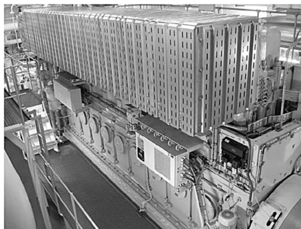
Рис. 4. Двигатель со стороны выпуска. Видны две распределительные коробки и блок ЕСМ
