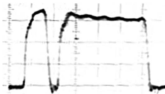
Рис. 1. Давление топлива при двухфазном впрыске
