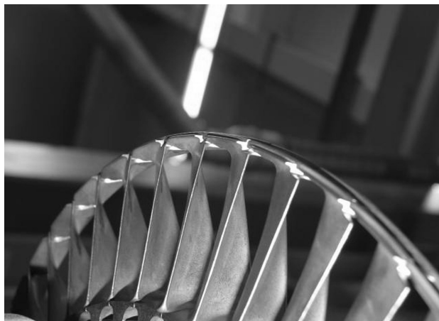
Рис. 1.7. Конструкция и характеристика турбины с покрывающим диском
