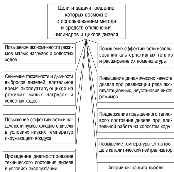
Рис. 7. Систематизация целей и задач, решаемых с помощью рассматриваемого метода и реализующих его средств
