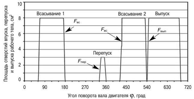
Рис. 4. Изменение площадей отверстий впуска, перепуска и выпуска в зависимости от угла ПВ
