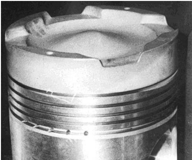
Рис. 3. Поршень с оксидно-керамическим слоем поверхности камеры сгорания
