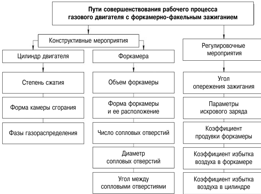
Рис. 2. Пути совершенствования рабочего процесса газового двигателя с форкамерно-факельным зажиганием
