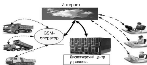
Рис. 3. Виртуальная информационная сеть контроля работы автосамосвалов
