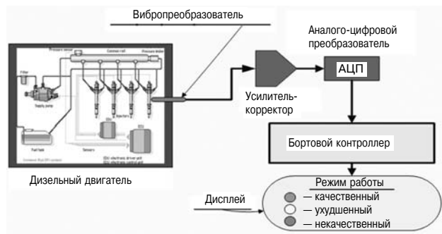
Рис. 2. Схема электронной системы ультразвукового контроля впрыска топлива
