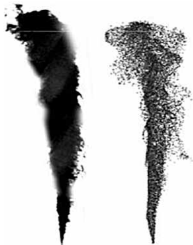
Рис. 4. Сравнение результатов наблюдения (слева) и моделирования (справа) факела распыла (Wartsila)
