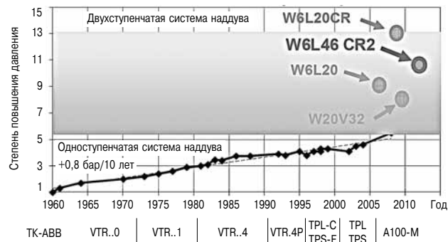
Рис. 4.1. Хронология испытаний двухступенчатых систем наддува на двигателях фирмы «Wartsila»
