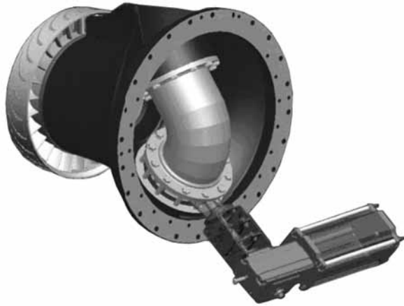
Рис. 15. Конструкция газоподводящего корпуса с клапаном управления
