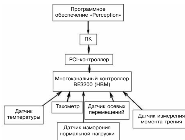
Рис. 4. Схема информационно-измерительной системы
