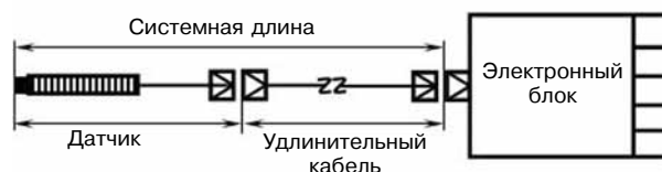
Рис. 3. Схема вихретоковой системы
