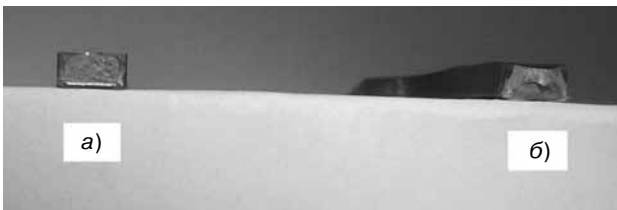
Рис. 1. Сталь 40Х. Изломы образцов после испытания на динамический изгиб:
