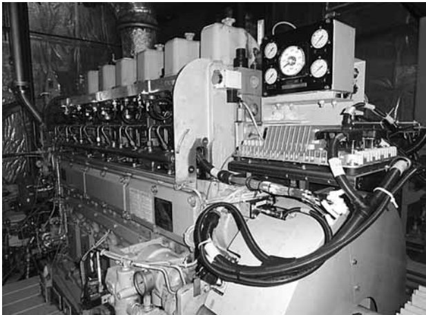
Рис. 11. Система EUP на вспомогательном двигателе (на испытательном стенде)
