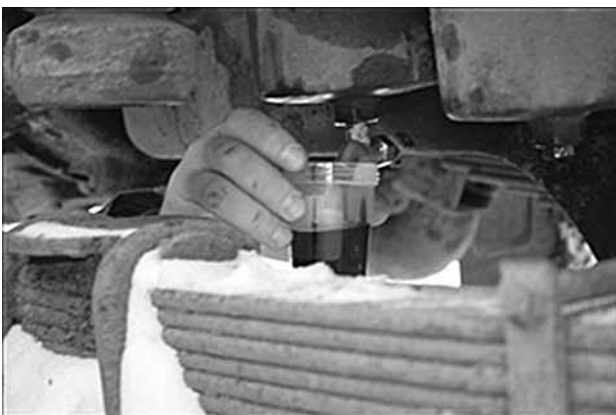
Рис. 3. Осуществление отбора пробы масла
