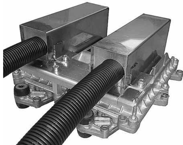
Рис. 4. Защитные устройства для разъемов контроллера EDC17CV41
