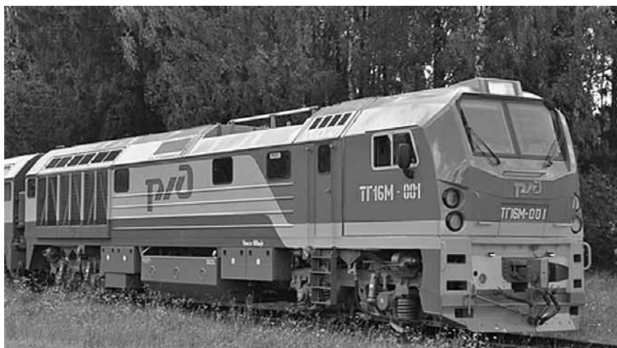
Опытный образец магистрального двухсекционного грузового тепловоза ТГ16М производства Людиновского тепловозостроительного завода (ЛТЗ, входит в холдинг «Синара-Транспортные Машины») проходит приемочные и сертификационные испытания в «Научно-исследовательском и конструкторско-технологическом институте подвижного состава» (ВНИКТИ, г. Коломна). Ранее тепловоз успешно прошел заводские испытания, результаты которых подтвердили
