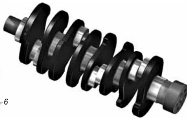
Рис. 1. Схемы кривошипно-шатунного механизма двигателей типа W8:
