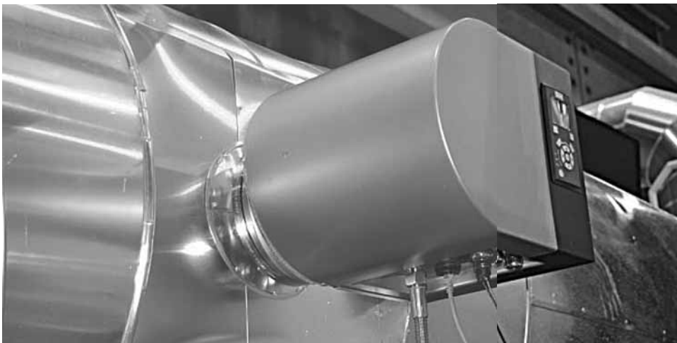
Рис. 2. Danfoss IXA облучает ультрафиолетовым излучением поток отработавших газов и принимает отраженный сигнал при помощи спектрометра, размещенного в защитном кожухе вне системы выпуска
