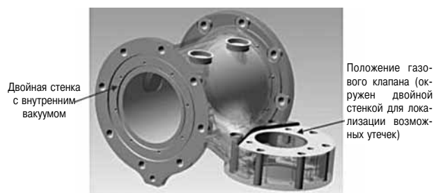
Рис. 18. Фрагмент газовой трубки двигателя 35/44DF с двойными стенками
