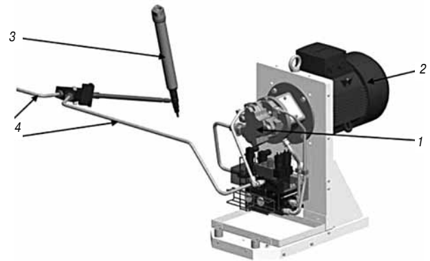
Рис. 15. Система впрыска пилотного топлива двигателя 35/44DF
