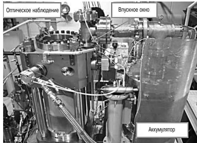
Рис. 4. RCEM с цилиндрической камерой сгорания
