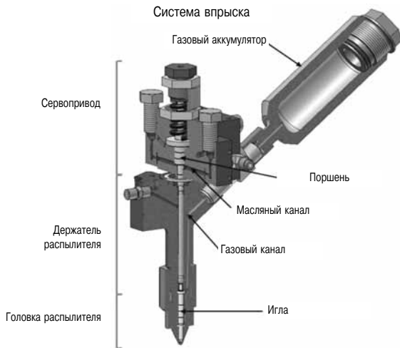
Рис. 2. Газовая форсунка и аккумулятор
