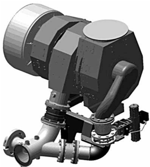
Рис. 16. Турбокомпрессор двигателя 35/44DF
