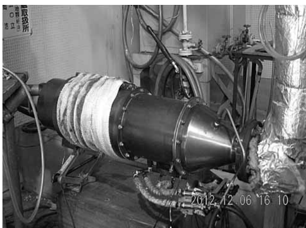
Рис. 16. Фильтр DPF новой конструкции, врезанный в выпускную систему двигателя
