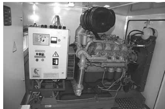
Рис. 4. Передвижной комплекс сварочных работ (ПКСР-М) на шасси спецавтомобиля КамАЗ с электроагрегатом мощностью 100 кВт
