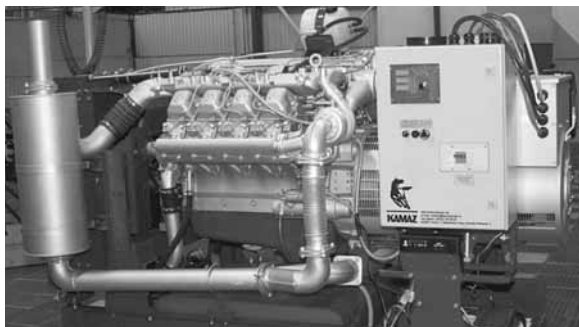
Рис. 1. Электроагрегат дизельный АД 150С-Т400-1Р
