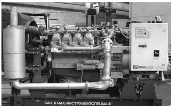
Рис. 2. Электроагрегат газопоршневой АП 100С-Т400-1Р
