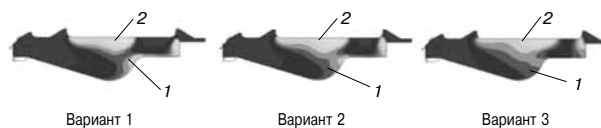
Рис. 7. Коэффициент избытка горючего в ВМТ при различных давлениях впрыска, диапазон от 0 (область 1) до 0,55 (область 2)
