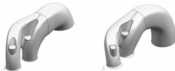
Рис. 7. Два варианта впускного патрубка
