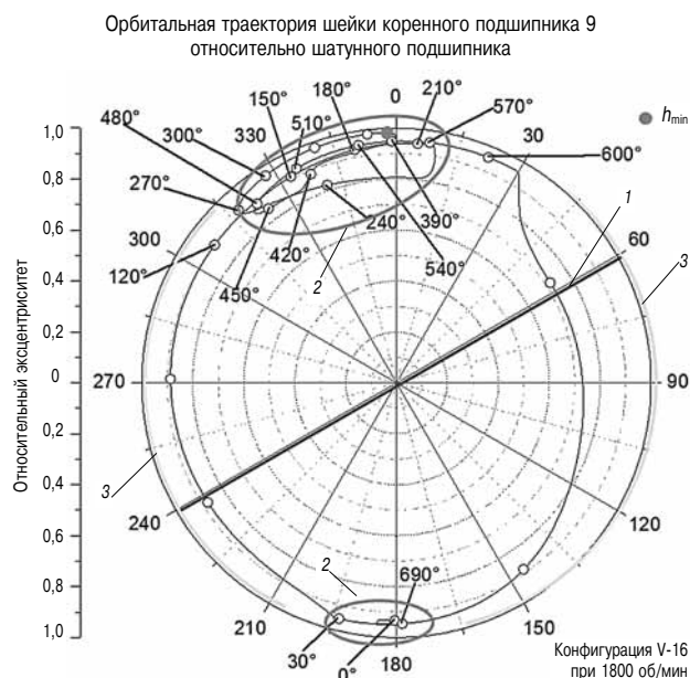
Рис. 11. Выбор оптимального положения маслонапорных отверстий в коренных подшипниках: 1 — выбранное положение масляного сверления; 2 — большая длительность подачи при высоком эксцентриситете; 3 — возможные положения масляного сверления при меньших значениях эксцентриситета и длительности подачи
