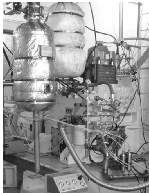
Рис. 24. Опытный одноцилиндровый отсек на стенде УДМЗ
