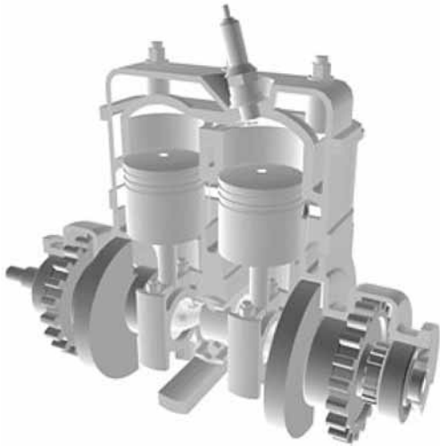
Рис. 3. ДВС 2Д-200 с бесшатунным силовым механизмом конструкции А.И. Костина
