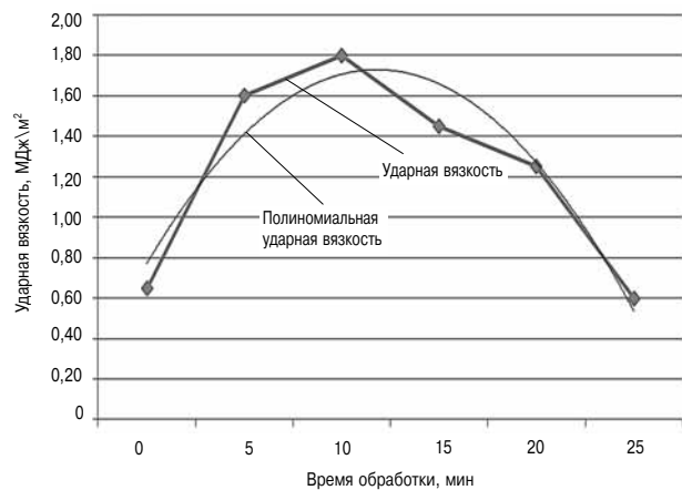
Рис. 4. Сталь 40X холодный прокат. Зависимость КСУ от продолжительности обдува. Образец размещался возле рассекателя газоструйного генератора
